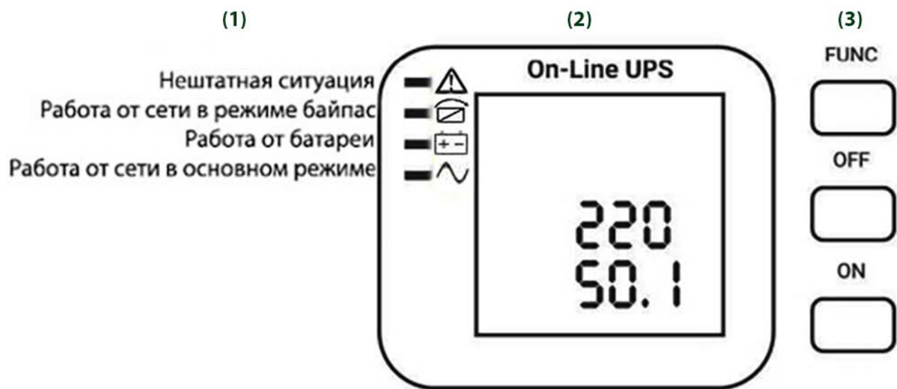
Рис.3. Панель управления ИБП
