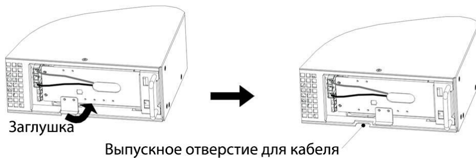
Рис. 6 а Удаление заглушки выпускного отверстия в ИБП.
