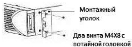
Рис.3 Установка монтажных уголков
