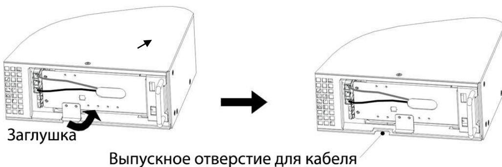
Рис. 2а Снятие кабельной заглушки ИБП.
