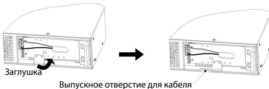
Рис. 6 а Удаление заглушки выпускного отверстия в ИБП.
