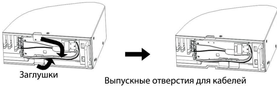
Рис. 6 б Удаление заглушки выпускного отверстия в ДВББ.
